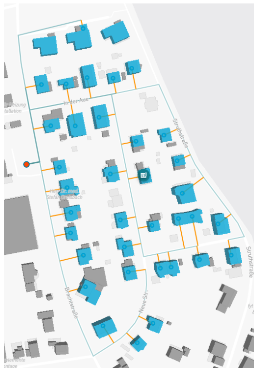
Abbildung 41: Festlegung Netzumgriff, Netzberechnung, Kostenschätzung bei 70 % Anschlussgrad (Beispiel) (eigene Berechnung IU / INFRA | Wärme ©)
